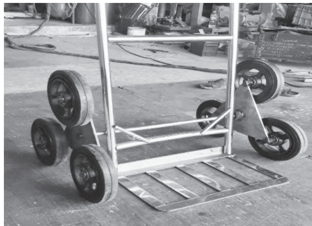
ภาพที่ 8 แสดงการพัฒนาล้อที่ใช้ในการขับเคลื่อนของรถเข็น
