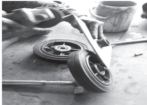
ภาพที่ 3 ทำการตัดและเชื่อมตัวยึดล้อรถเข็นพร้อมเจียร์แต่งตัวยึดล้อ
