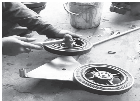
ภาพที่ 4 ทำการประกอบล้อรถเข็นเข้ากับตัวยึดล้อ
